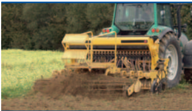
Tren de cultivo grada rotativa + sembradora + rulo.
