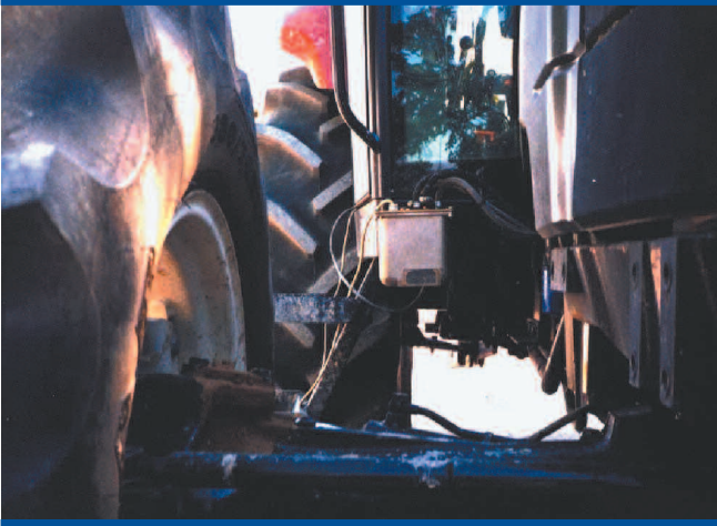
Figura 3A y 3B: Caudalímetro de fuel: Elemento. Ubicación
