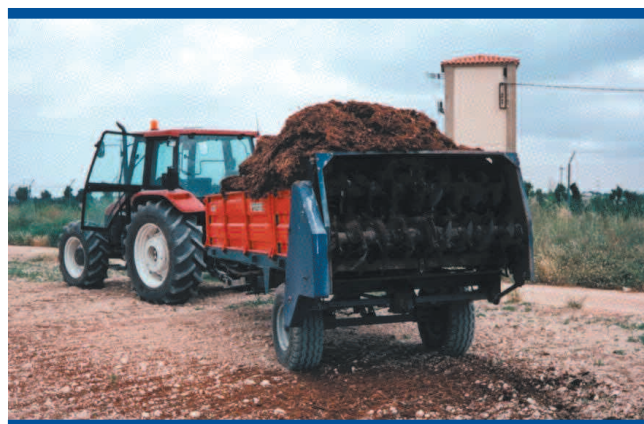
Figura 27: Remolque esparcidor de estiércol
