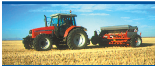
Figura 18: Sembradora a chorrillo para siembra directa
